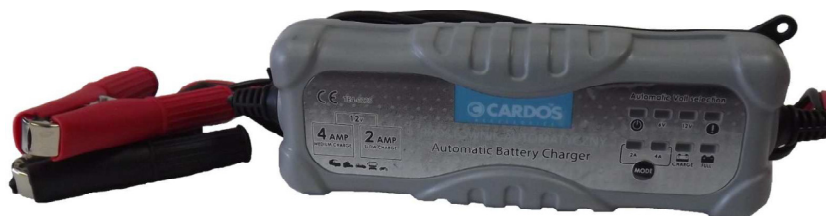
35 AA 108 6V og 12V / lader med 2 og 4 Amp automatisk ladespænding Ingen risiko for overopladning Overophedningsbeskyttelse Fuld beskyttet mod kortslutning og forkerte tilslutning
